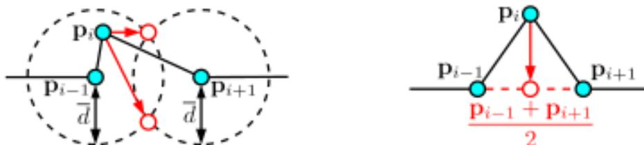
FIG. 3.4 – Minimisation de  $E_{\text{continuité}}$  (gauche) et  $E_{\text{courbure}}$  (droite). Les positions qui minimisent  $E_{\text{continuité}}$  sont les intersections des cercles, tandis que celle qui minimise  $E_{\text{courbure}}$  est le barycentre des voisins
